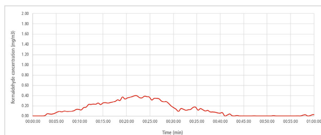
Fig. 4: Formaldehydemissionen fra nyfremstillede coldbox kerner sværter med konventionel vandsværte (øverst) og Semco FF-vandsværte (nederst).
