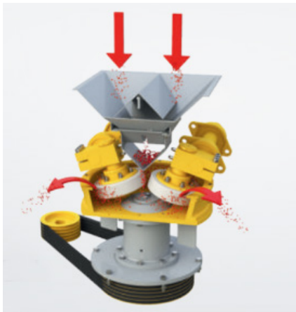
Fig. 3: Friktionsprincip i USR-II
