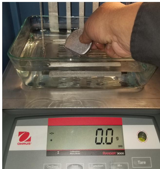
Fig. 4: Densitetsmåling er sikker, hurtig og nøjagtig.
