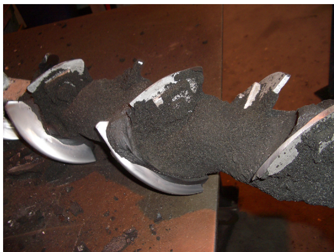
Fig. 14: Mangelfuld rengøring af mixersnegl
