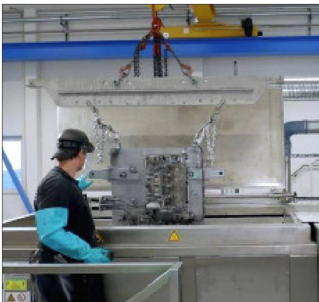
Fig. 11: Rengøring af kernekasser vha. ultralyd
