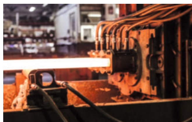
Fig. 6: Kokille og jernstrengen. Fotokreditering: Tasso A/S
