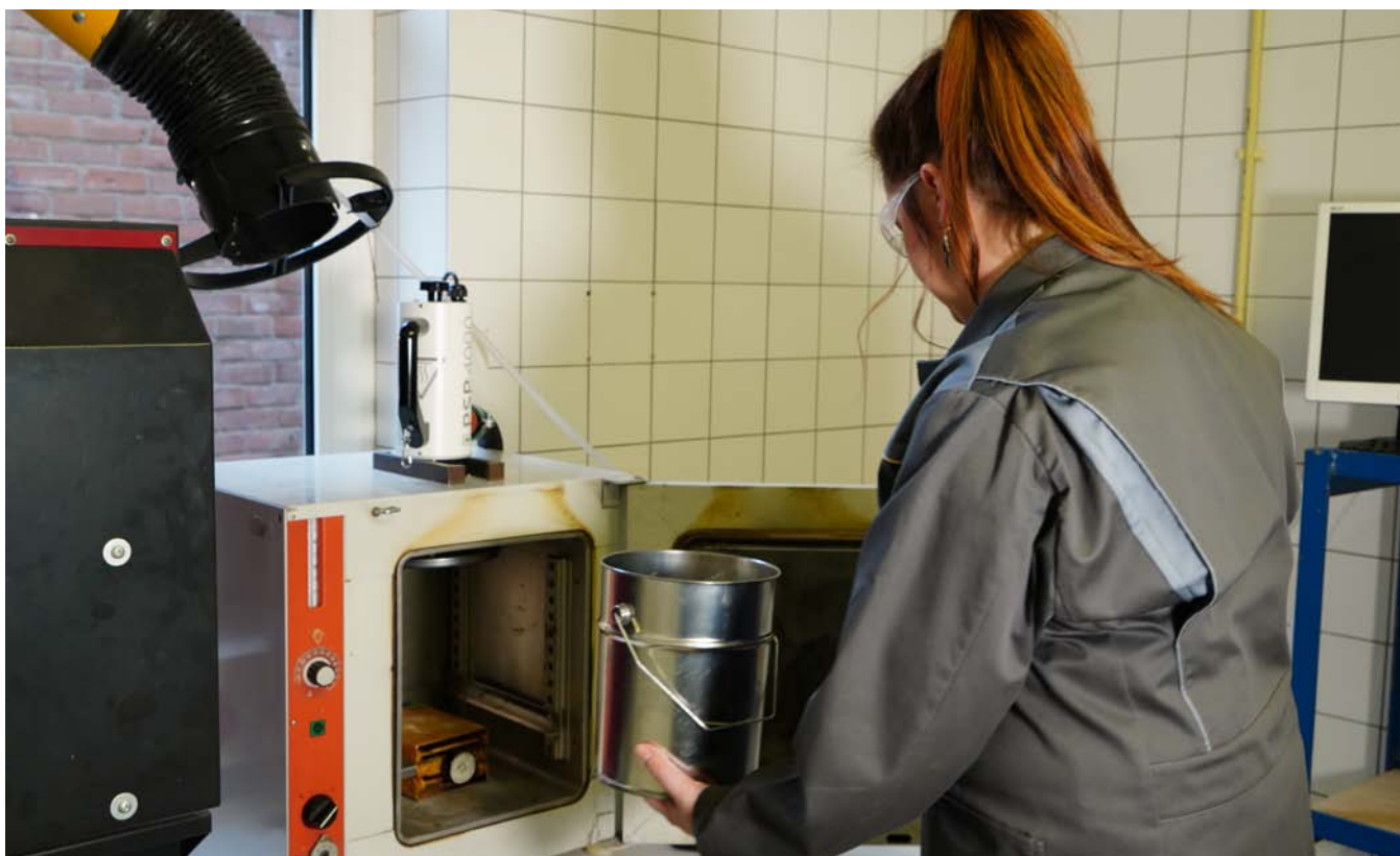
Fig. 6. Prøvebeholder placeres i tørreovn
