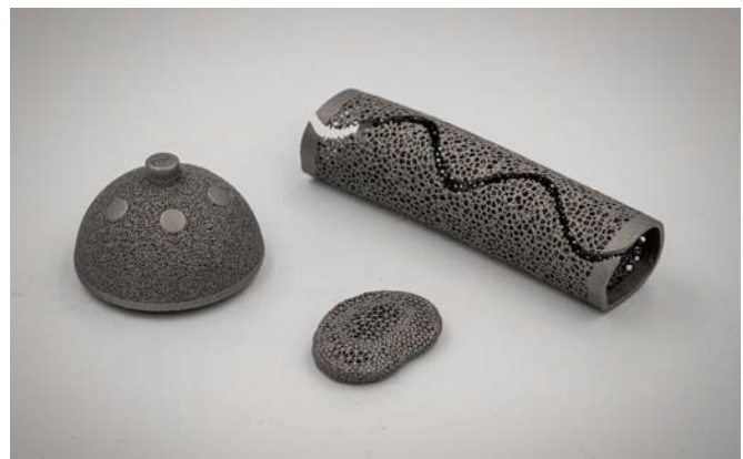
Implantater printet med Laser Powder Bed Fusion i titanium på Teknologisk Institut
