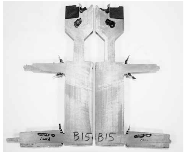
(b) Gennemskæring af et blok-emne for at finde porositeter
