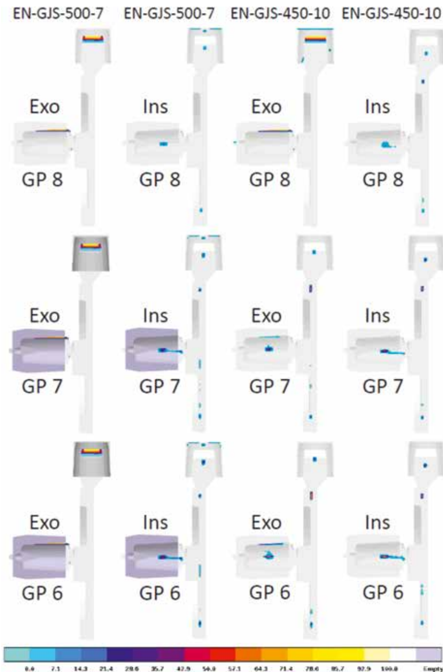
Figur 4: Porøsitetsresultater for test og kalibrering af simuleringerne for skive-emnerne. Her set fra siden. GP er grafitudvidelsesfaktoren.
