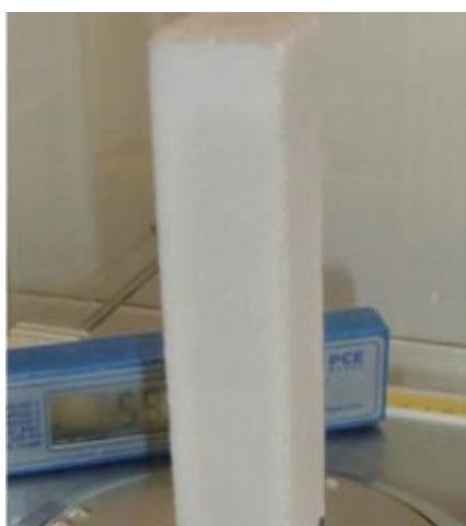
Fig. 10. Bøjeprøve med tydelig fugtig / mørkere midterparti.
