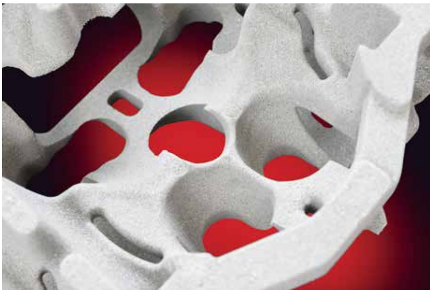
Figur 18. Sektion fra vandkammerkerne 03HD
