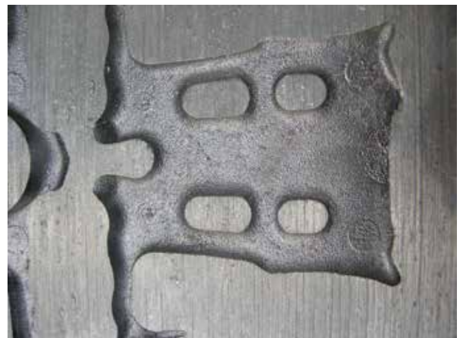
Fig. 12: Ingen penetration ved anvendelse af forbedret additiv til SOLOSIL TX
