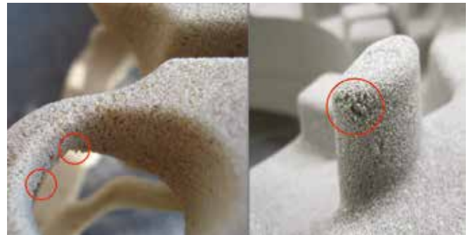
Fig. 4: Mangelfuld komprimeret kerne ved brug af uorganisk bindemiddel
