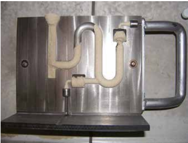
Fig. 5: Specialkernekasse til bedømmelse af flydeevnen
