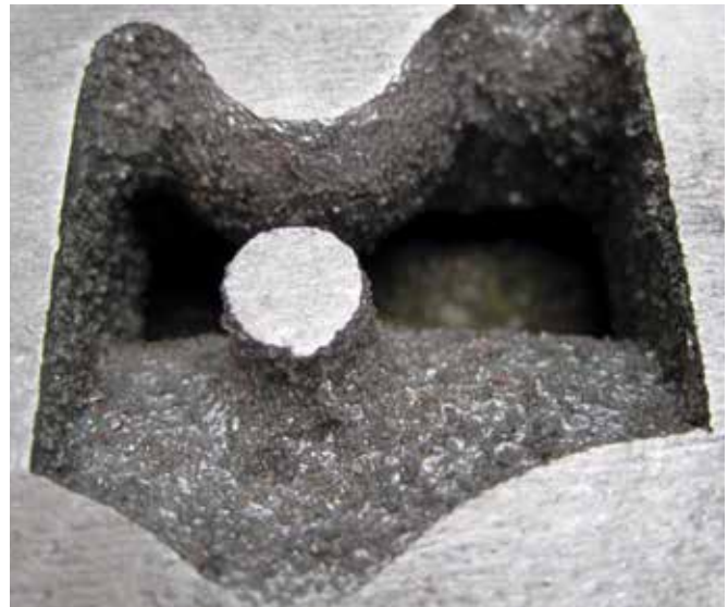
Fig. 11: Kraftig penetration på vandkammerkerne
