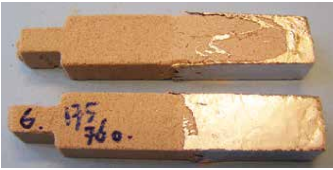
Fig. 9: Dip-test resultater for 2 forskellige uorganiske bindere
