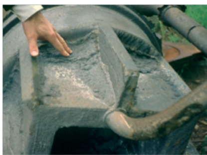
Fig. 7: Sintring i hot spot områder
