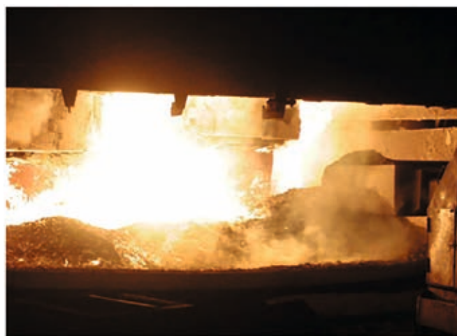
Fig. 8: Ovnladning, de lodrette strukturer i ovnen er elektroderne.
