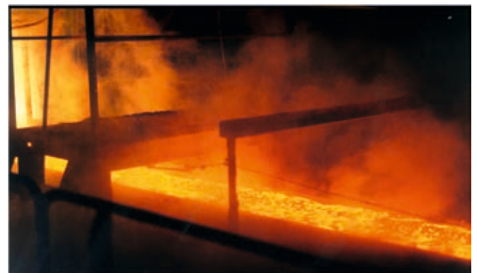
Fig. 13: Strengstøbning af FeSiMg
