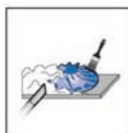
Fig. 6: Efter det sidste lag er anbragt fjernes det løse sand
