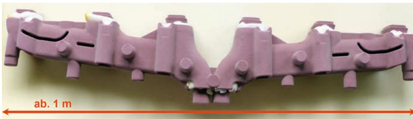
Fig. 11: Konventionelt fremstillet kerne til en manifold
