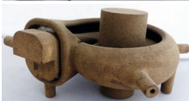
Fig. 10: Printet kerne til turboladerhus
