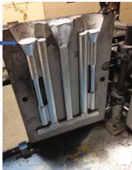
Fig 4: 16% Ce-legering; Formen til trækprøvestøbning blev ikke fuldstøbt.
