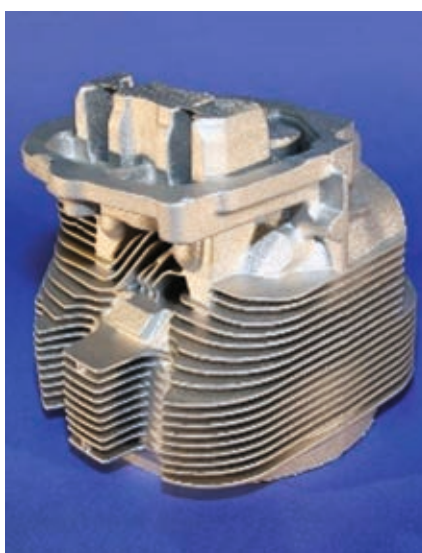
Fig. 7: Et velstøbt cylinderhoved i en 8% Ce binær legering.
