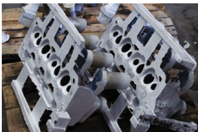
Fig. 9: Topstykker støbt i grønsand med en Al-Ce-Mg legering
