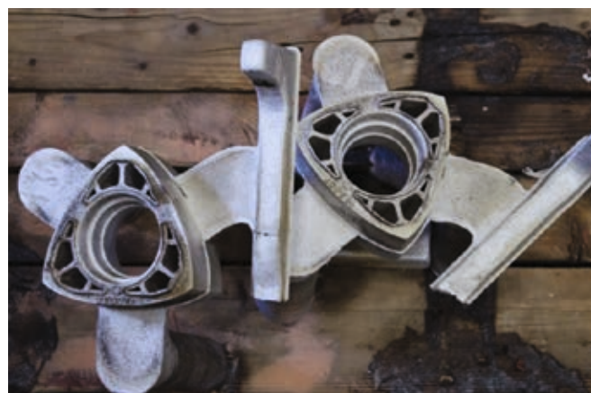
Fig. 10: Eksperimentel rotor-motor støbt i kemisk bundet sandform med en Al-Ce-Mg legering.
