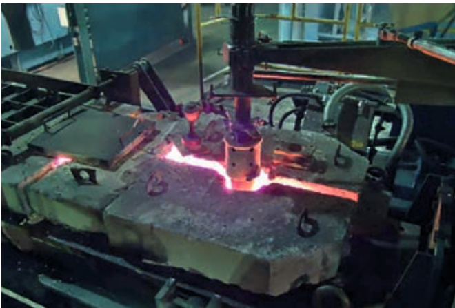
Fig. 8: Accumetrix™ temperaturmåling hos MAT Jernstøberi, Tyskland
