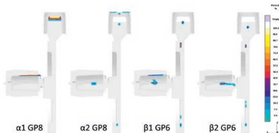
Figur 6. Simulering af porøsiteter i emnegrupperne \alpha 1 , \alpha 2 , \beta 1 og \beta 2 . 3D modellen er gennemskåret på midten i den vertikale symmetriakse, på samme måde som de støbte emner var blevet. Simuleringen af \alpha 1 og \alpha 2 benytter en grafitekspansionsfaktor på 8, mens simuleringen af \beta 1 og \beta 2 benytter en grafitekspansionsfaktor på 6.
