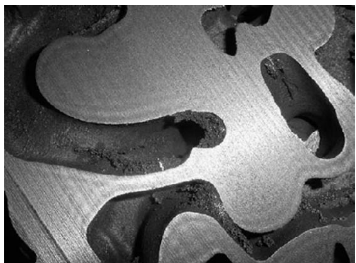
Fig. 13: Påbrændinger og penetration
