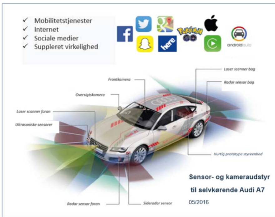
Fig. 7: Strømkrævende udstyr til selvkørende biler
