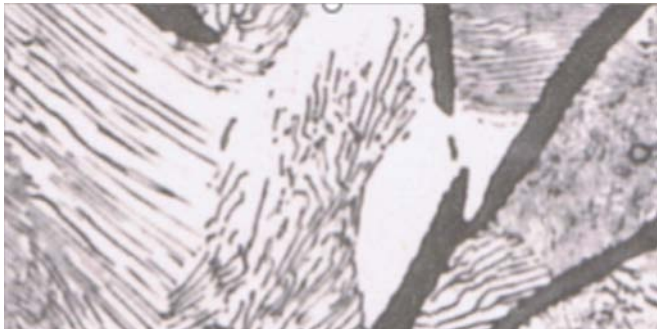
Fig. 8: Grafitlameller i perlitisk grundstruktur.
