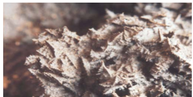
Fig. 21: Dendritter i støbetap (Cees van de Velde).
