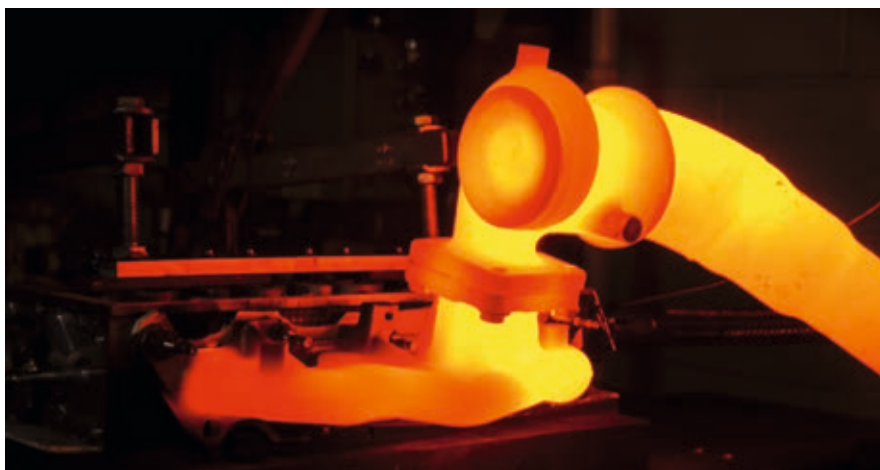
Fig. 5: Afprøvning med en motorudstødningsmanifoldsimulator (EES) ( www.wecast.com )
