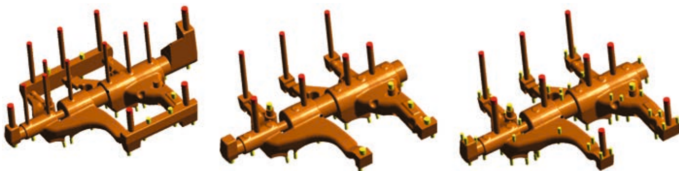
Figur 13: Udviklingsforløbet ved design af en kernekasse (a til c): Grundlæggende mulige ændringer af kernegeometrien og dysetildeling (skydedyser rød, udluftningsdyser gul) for en produktionseget kernekasse kræver tidlig planlægning fra start til slut.
