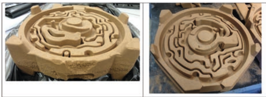
Figur 10: a) Ventilhuskerne, som i bunden ikke er fuldstændigt afhærdet og b) efter optimering.
