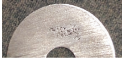
Fig. 5: Synlige mikrosugninger i SG-jern
